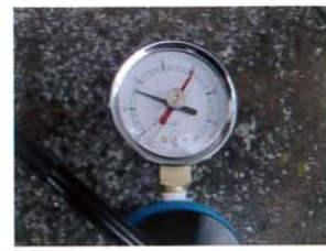
(スパイクの引き抜き試験) 躯体：シンダーコンクリート 計測結果：4000N/mm 2 ドリル径：φ4.8mm
