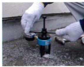
(スパイクの引き抜き試験) 躯体：シンダーコンクリート 計測結果：4000N/mm 2 ドリル径：φ4.8mm
