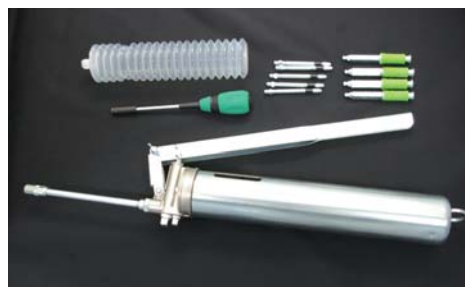
(上から右へ) 蛇腹容器 (400cc)、注入プラグ、ナットドライバー (φ7mm)、高圧注入ポンプ (245kgf/cm 2 )
